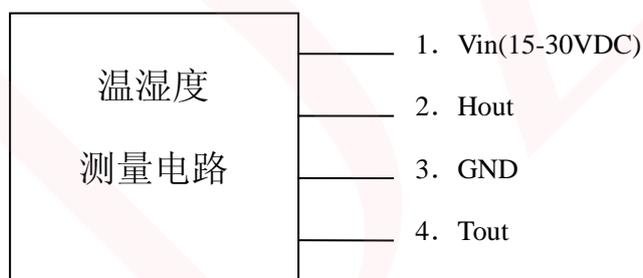
图 3. 电气连接线.
